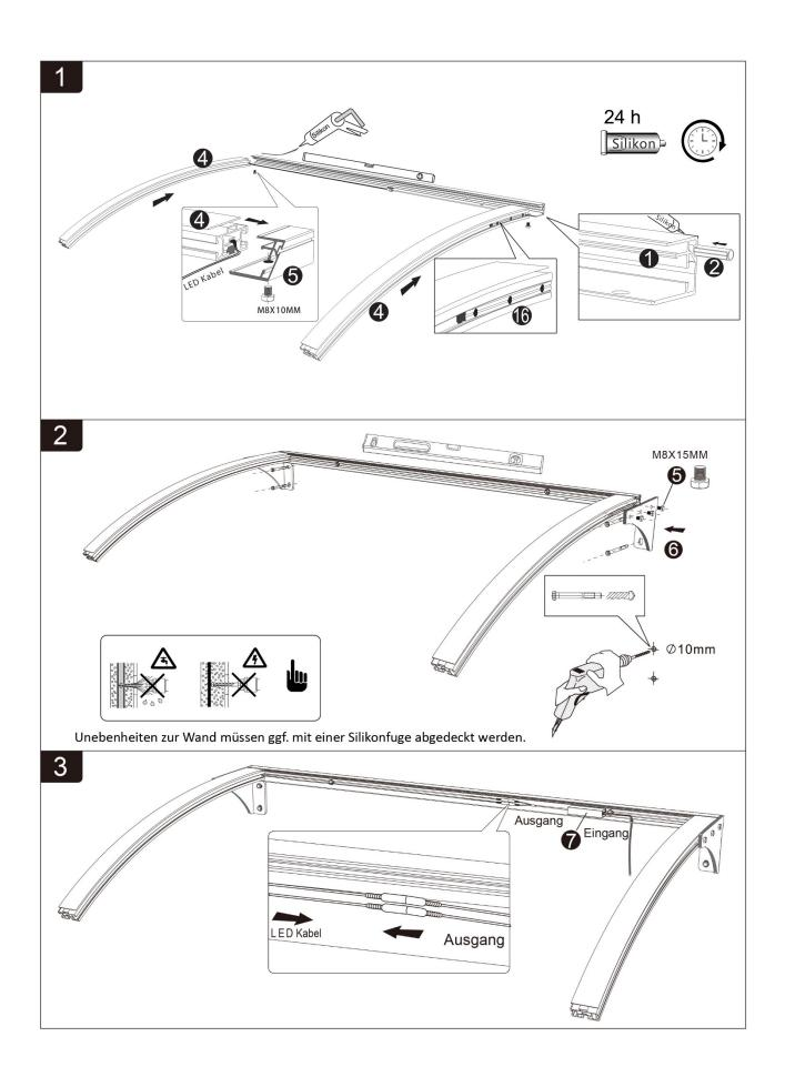
Bohren Sie entsprechend Ihren örtlichen Gegebenheiten ein 10 mm Loch in die Wandschiene. Setzen Sie Teil Nr.16 in das Loch und führen Sie das Spannungsversorgungskabel ein.
