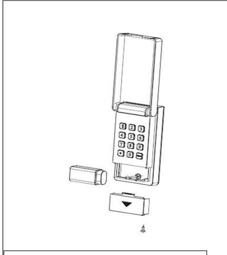
**Schritt 2:** entfernen Sie die Schraube am unteren Ende des Codetasters. Öffnen Sie die Schiebeklappe und entfernen Sie die Batterie. Stecken Sie nun die zweite Schraube durch das Loch in der Rückseite des Codetasters und ziehen Sie diese anschließend fest.
