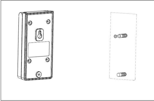
**Schritt 1:** zeichnen Sie die beiden Löcher auf Ihrem Mauerwerk an. Bohren Sie die beiden Löcher mit dem passenden Bohrer und stecken Sie anschließend die Dübel hinein. Schrauben Sie nun in den oberen Dübel eine der beiden Schrauben rein, sodass der Kopf noch etwas heraussteht und Sie den Codetaster mit der oberen Lasche fest einhängen können.
