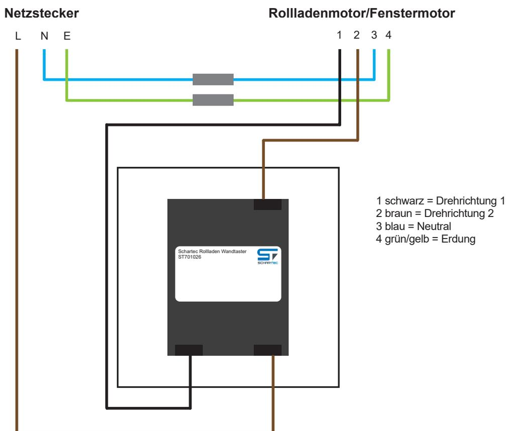
Wenn der Motor sich nach unten bewegt, obwohl Sie die Taste nach oben gedrückt haben, wechseln Sie einfach den Steckplatz der braunen und schwarzen Kabel des Motors
